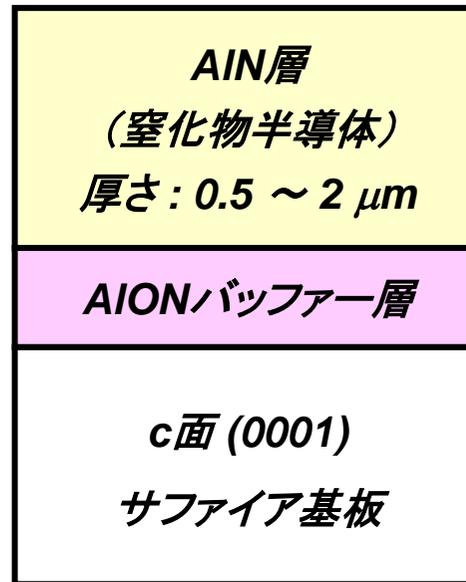
図2: サファイア基板( $\text{Al}_2\text{O}_3$ )とAIN層の間にAIONバッファー層を入れてAIN層を高品質化
