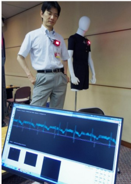
生体データをLEDの点滅に変えて送信する技術。電波が足りなくなる大人数でも対応できる
