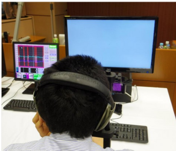
音に合わせて瞳孔が動いていることを検知して注意を引きつけやすい音を探る技術
