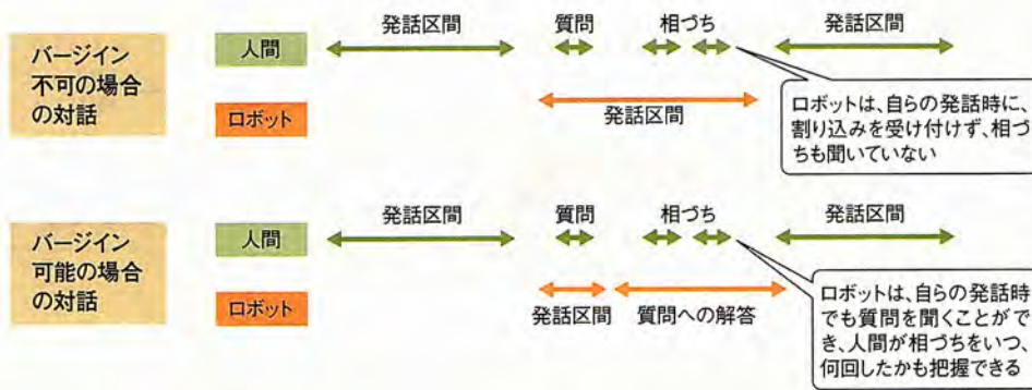
図6 自然な対話にバージンは必須 フェアリーデバイセスが指摘する音声認識システムのバージン (barge in) 機能の重要性を示した。バージン機能がない場合、ロボット自身の発話中、ロボットは外からの声を聴くことができないため、話が終わるまで質問などを受け付けず、聞き手の相づちも音声としては把握できない。一方、バージン機能が有効である場合は、聞き手の質問などを受け付けることができ、相づちにも気づきやすい。
