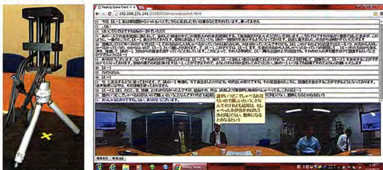
図6 4~8個のマイクは標準搭載になるか NTT-CS研が、CHiME-3で用いた音データの収集機を再現し、さらに開発した音声認識システムも実装した (a)。また、CHiME-3の音声認識システムを、複数の話者が話す場合に応用した例 (b)。集音マイクは8個のマイクアレーから成る。
