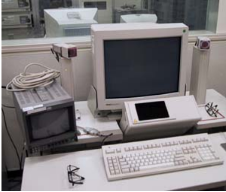
図 5: 視線測定装置 EMR-NC. ディスプレイ左右のカメラで三角枠を追尾し, ディスプレイ下部のカメラで眼球を撮影する.
